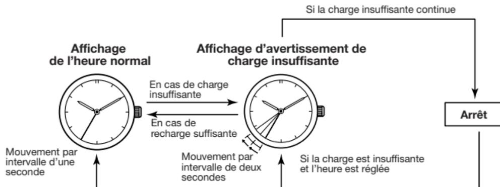
Lorsque la montre est exposée à la lumière, la fonction de mise en marche rapide commence à fonctionner et la trotteuse commence à se déplacer. L'heure exacte peut être réglée dès que la montre est pleinement chargée.
