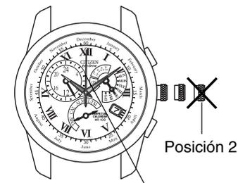
Cuando la corona es extraída demasiado a la posición 2, la manecilla de segundos se mueve a la posición de 0 segundos y se para, y el reloj ingresa en el modo de corrección.
