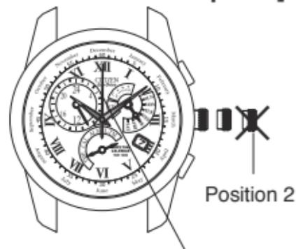
Lorsque la couronne est tirée jusqu'à la position 2, la trotteuse se met en position 0 seconde et s'arrête, et la montre se met en mode de correction.
