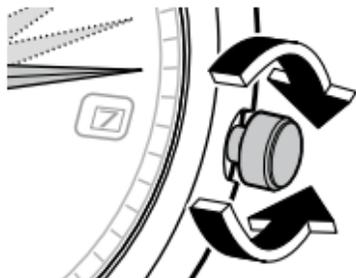
Déplacez l'aiguille des minutes au-delà de l'heure correcte de 5 « minutes » et replacez ensuite l'aiguille en position appropriée pour les « minutes ». Ceci minimisera l'effet de jeu dans l'engrenage et permettra un mouvement plus précis de l'aiguille.
