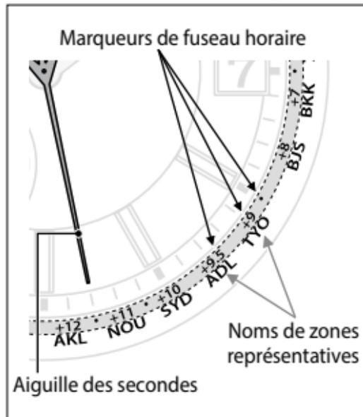
Dans l'illustration de gauche, l'aiguille des secondes indique 28 secondes et le réglage de fuseau horaire est "+11,5".
