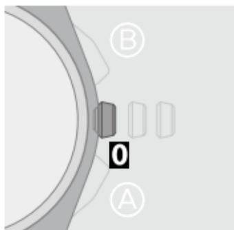
**3** Faites pivoter la couronne pour ajuster le réglage si la seconde intercalaire n'est pas correcte.
